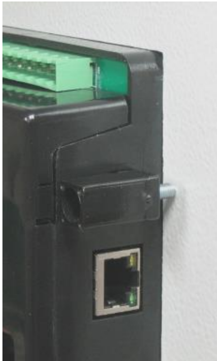
Instalación de la traba tipo tornillo
