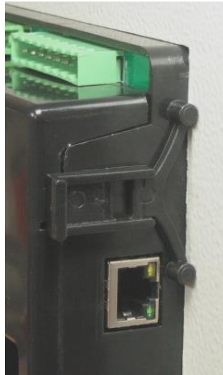
Instalación de la traba tipo autoajustable.
