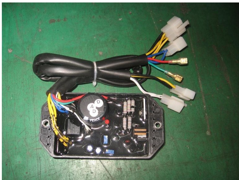
三相 AVR 型号：PLY-DAVR-50S3 各接线与电位器功能描述
